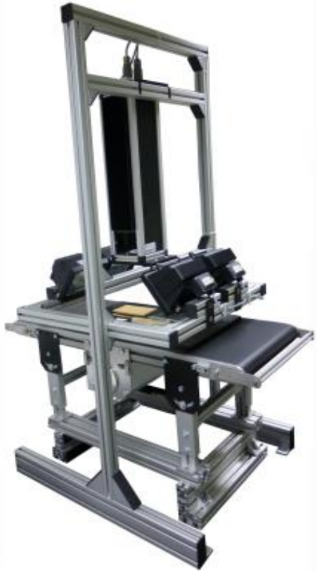
NIR- Hyperspektralkamera am WKI (800-2500nm)
