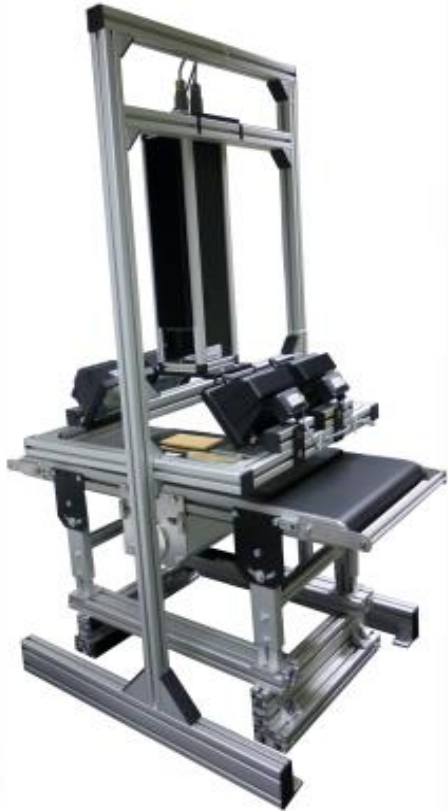
NIR- Hyperspektralkamera am WKI (800-2500nm)
