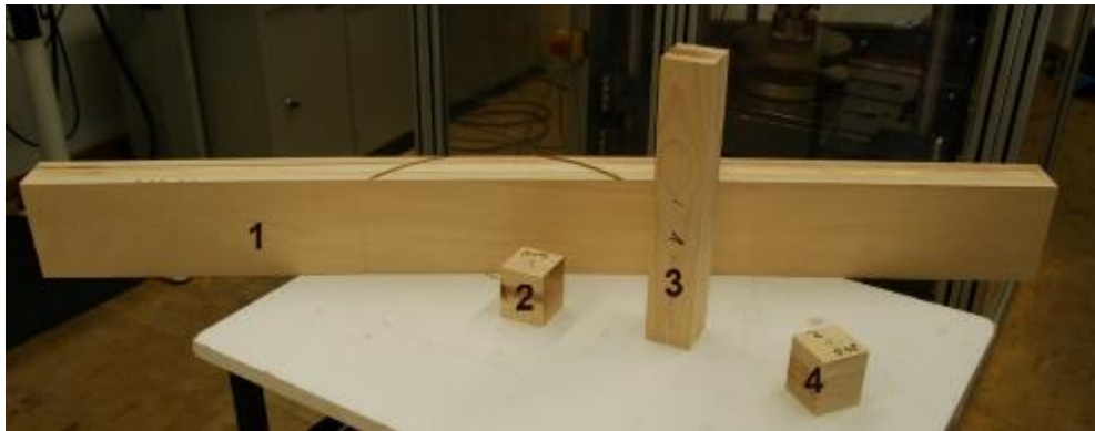
Proben für die Festigkeitsprüfungen (BSH), 1 = Biegeprobe; 2 = Druckprobe quer zur Faser; 3 Druckprobe in Faserrichtung und 4 = Blockscherprobe
